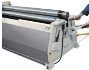
Standart Elle Açılabilen Sac Çıkarma Kafası Standart Manual Drop-End
