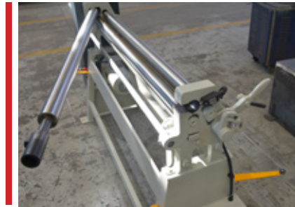
Standart Elle Açılabilen Sac Çıkarma Kafası Standard Manual Dropend
